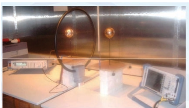
Слика 1. Теслините калемии и кружна антена поврзана со Спектрален анализатор
